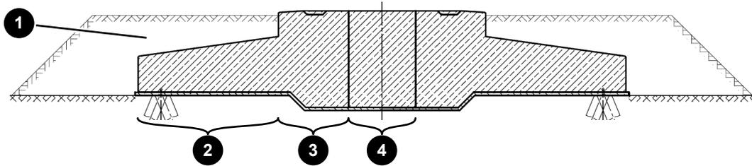
**Abb. 1: Fundament für Stahlturm mit Aufschüttung und Sohlvertiefung**
