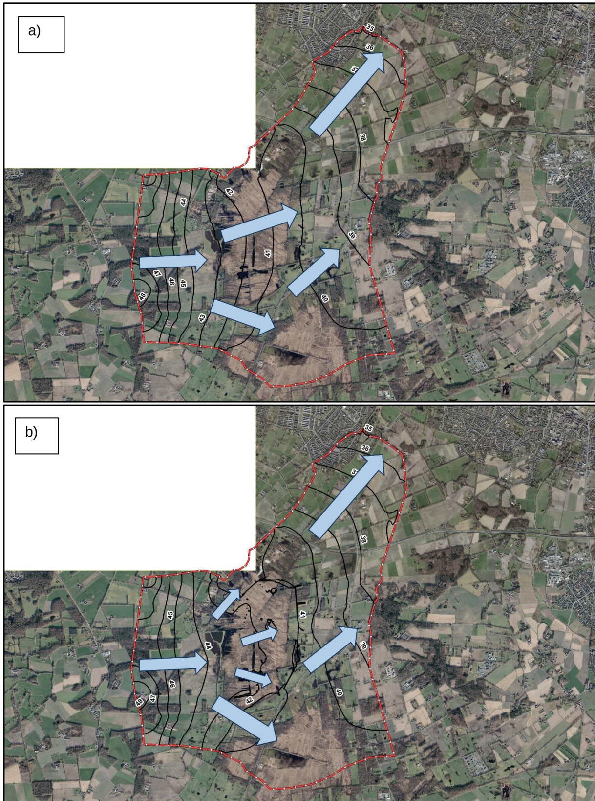
Abbildung 15: Schematische Darstellung der Hauptgrundwasserströmungswege (hellblaue Pfeile) im Vorhabenbereich (ProAqua 2024). a) Hauptströmungswege Referenzzustand im Bereich mit veränderten Grundwasserständen b) Strömungswege im Prognosezustand nach Anlage Dichtwand und Grundwasseranstieg
