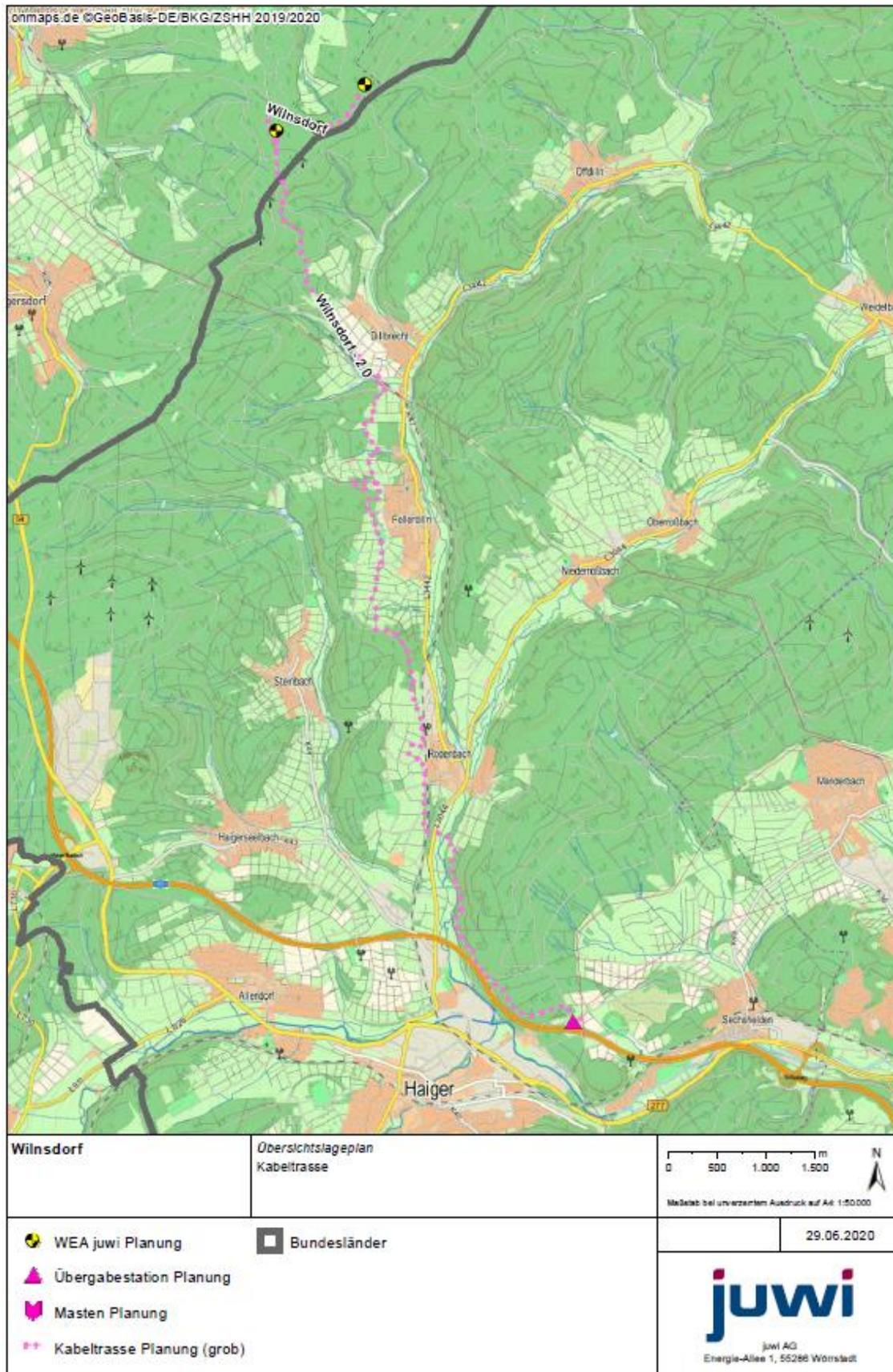
**Abb. 1:** Übersichtskarte mit geplanten WEA-Standorten und Grobplanung der geplanten Kabeltrasse zum Umspannwerk Haiger, ca. 12,5 km
