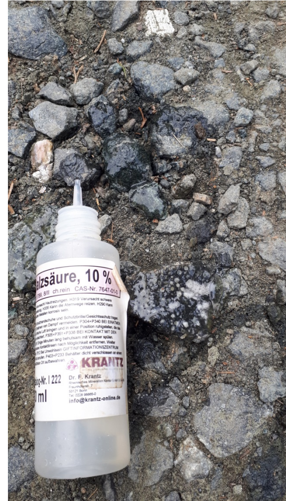
Bestandswege aus Kalkschotter, braust beim Salzsäuretest
