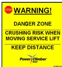
PERSONEN, DIE SICH AUF PLATTFORMEN IM TURM BEFINDEN, MÜSSEN ÜBER DIE GEFAHR DER QUETSCHUNG UND EINKLEMMUNG VON HÄNDEN, KOPF UND KÖRPER AUFGEKLÄRT WERDEN, DIE BESTEHT, WENN SICH DER AUFZUG IN DER NÄHE DER ABSTURZSICHERUNGEN UND PLATTFORMEN BEWEGT
