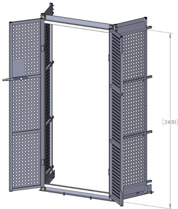
Diese Einfassung wird auf Plattformen verwendet, die als Bereiche mit hohem Risiko eingestuft werden (z. B. auf der Bodenplattform). Die Türen werden durch einen elektromechanischen Gate-Schalter überwacht, der die Stromzufuhr zum Transportaufzug komplett unterbricht, wenn die Türen geöffnet werden.
