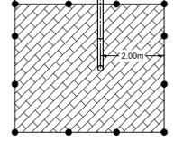
Ausführung der Ausbläserfläche mit herausnehmbaren Pfosten und doppelter Stahlkette ähnl. RN 267-029
