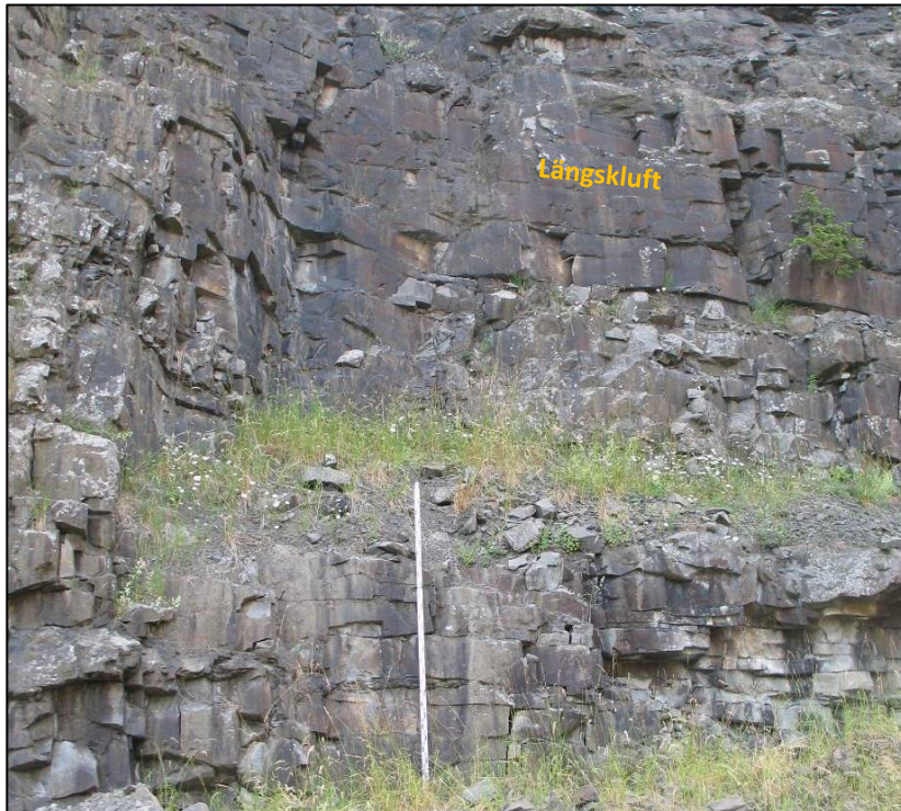
Abbildung 22: Orthogonales Trennflächengefüge mit fast söhliger Schichtung (Punkt O-1).
