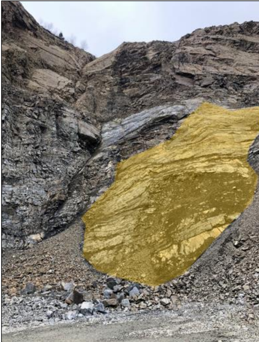
Abbildung 10: N-S verlaufende Störungsfläche im Südwesten des Steinbruchs (gelb markiert). Blick nach Südwesten
