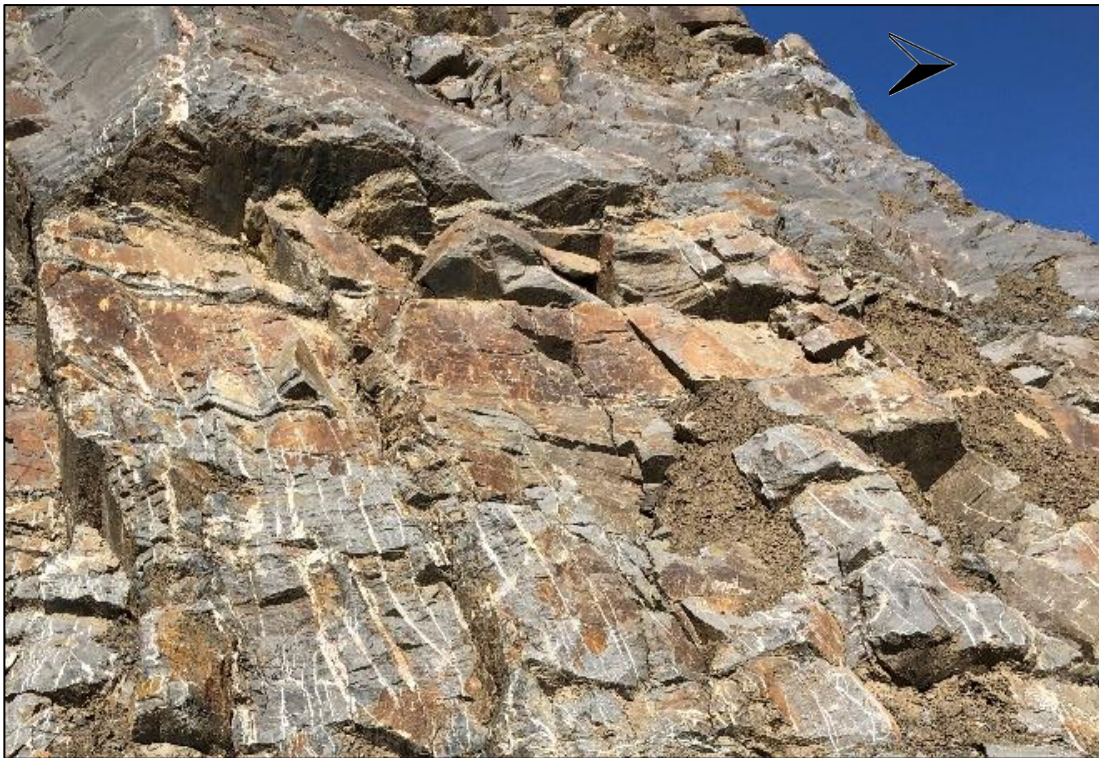
Abbildung 4: Westliche Abbauwand mit dunkelgrauen sandigen Siltsteinen und hellgrauen, bis braunen Sandsteinen darunter (Bildunterkante 2m)
