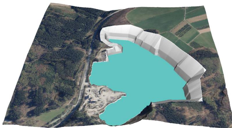
Abbildung 6: Endzustand nach Beendigung der Sumpfungmaßnahmen (Wasserstand bei 323 m NHN)
