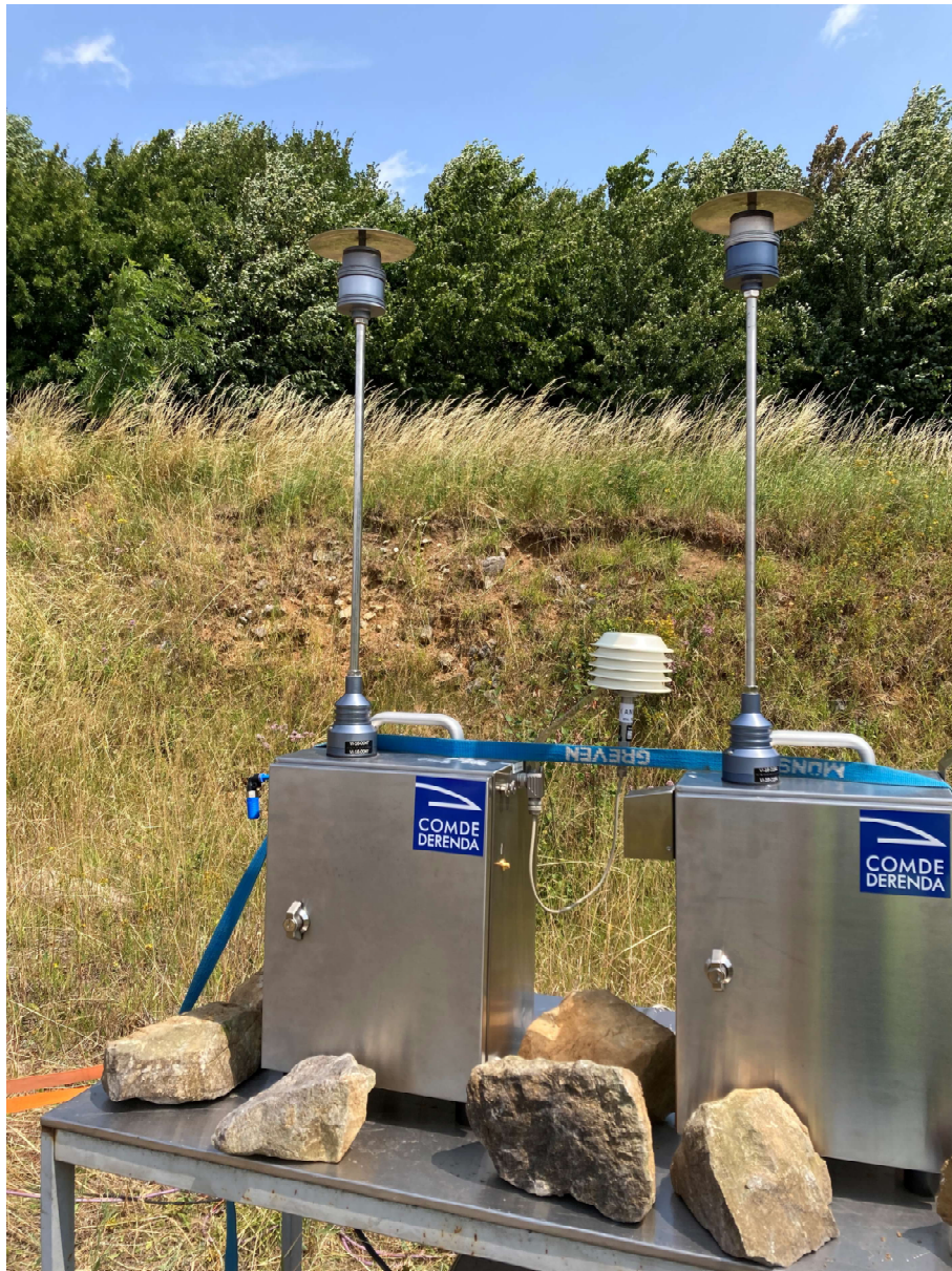
Abbildung A 34: MP 1 (Schwebstaubmessgeräte); Blickrichtung Osten/Werksgrenze.
