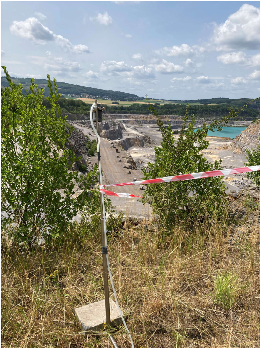
Abbildung A 35: MP 1 (Probenahmeeinrichtung für die Bestimmung von Kohlenwasserstoffen in der Außenluft); Blickrichtung Westen/Steinbruch.
