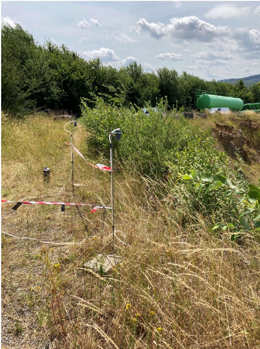
Abbildung A 36: MP 1 (Probenahmeeinrichtung für die Bestimmung von Kohlenwasserstoffen in der Außenluft); Blickrichtung Südost/Werksgrenze.
