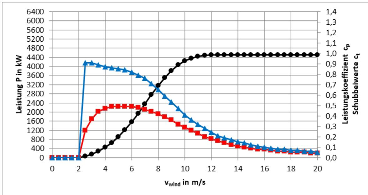
Abb. 1: Leistungs-, c<sub>p</sub>- und c<sub>t</sub>-Kennlinien E-175 EP5 / 6000 kW Betriebsmodus OM-106,0 dB
