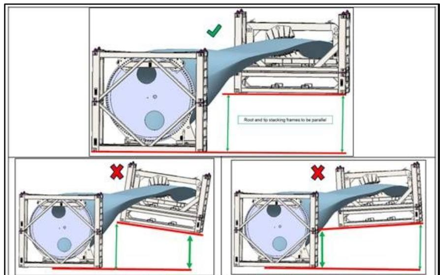
Abbildung 12: Anforderung an die Lagerung der Rotorblätter
