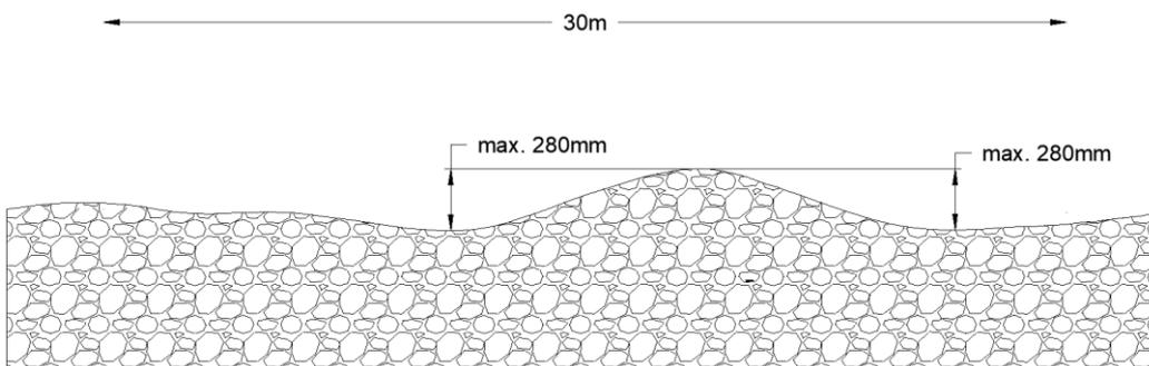
Abbildung 4: Bodenwellen auf Baustraßen / Bodenfreiheit von Transportfahrzeugen
