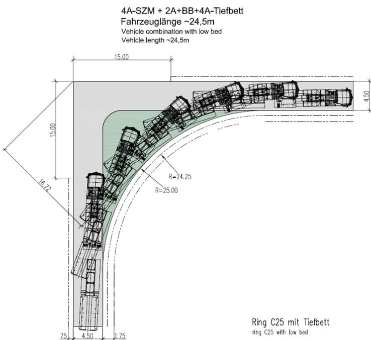
Abbildung 3: Kurvenradius für ein Fahrzeug mit Betonfertigteil (Beispiel)
