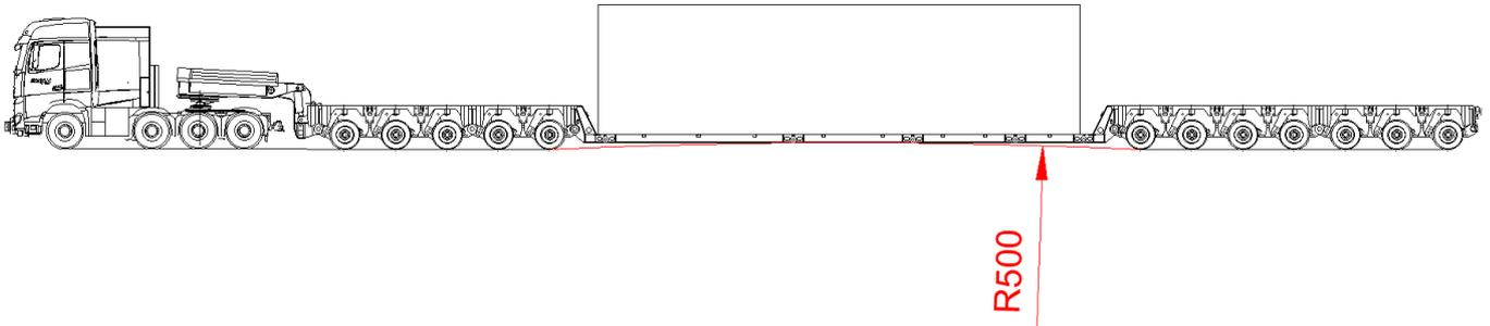
Abbildung 5: Bodenfreiheit von Transportfahrzeugen – Maschinenhaus (Beispiel)
