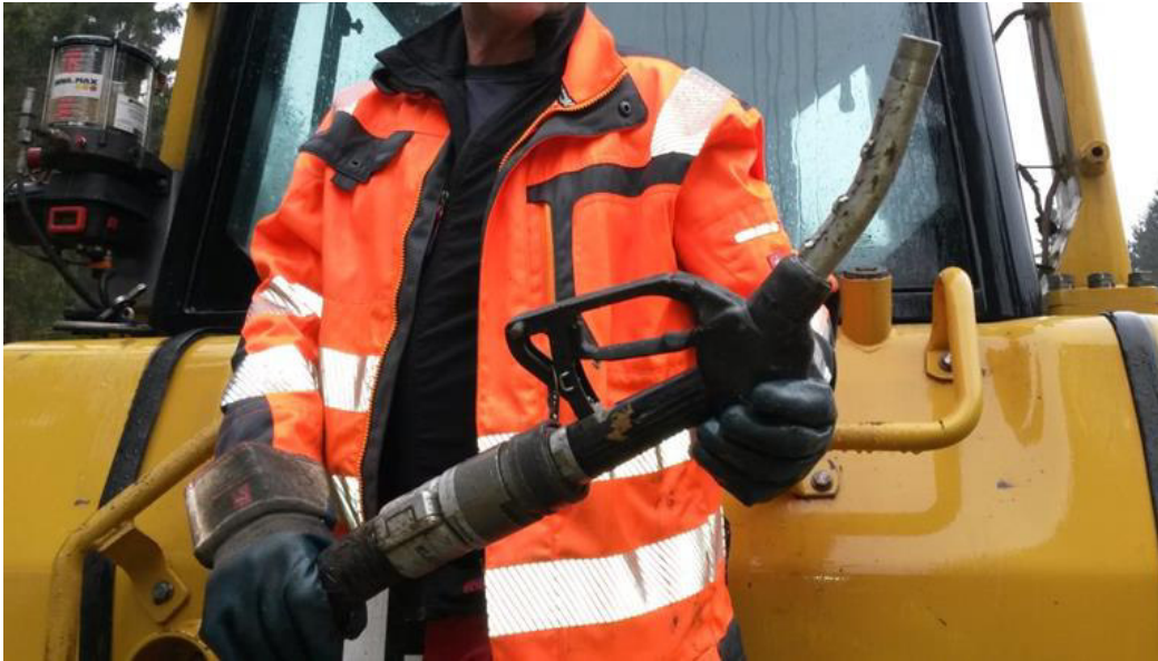
Abbildung 4: Empfohlene Maßnahme: Betankung von Baugerät mit rückschlaggesicherter Zapfpistole
