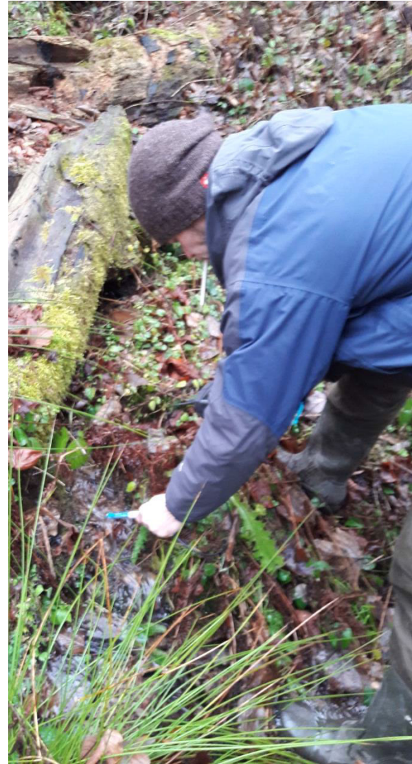
Messung der elektrischen Leitfähigkeit und des pH-Werts, Quellbereich Tiefe Hardt
