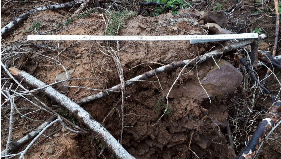
WEA 06, Bodenaufschluss an einem Wurzelteller: Geringentwickelte Braunerde über Sandstein
