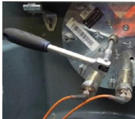
Abb. 16: Einlegen der Rotorsperre
