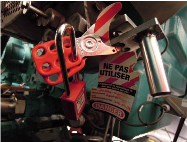
Abb. 14: Rotorsperre an der Hochdrehzahlwelle (HSS) mit LOTO gesichert
