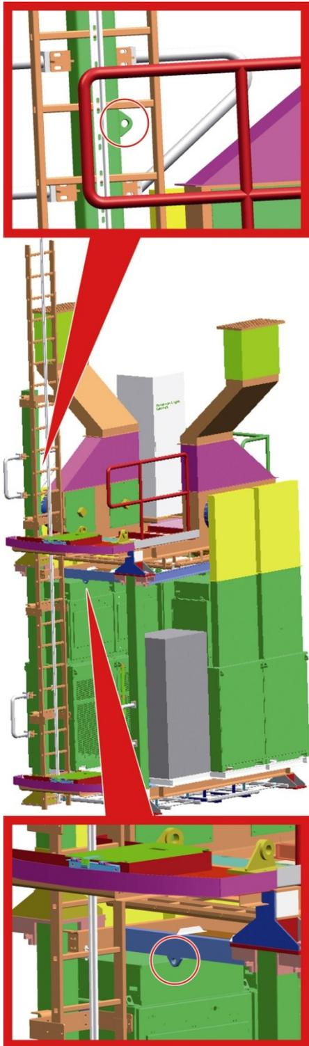
Abb. 24: Anschlagpunkte Umrichtersektion
