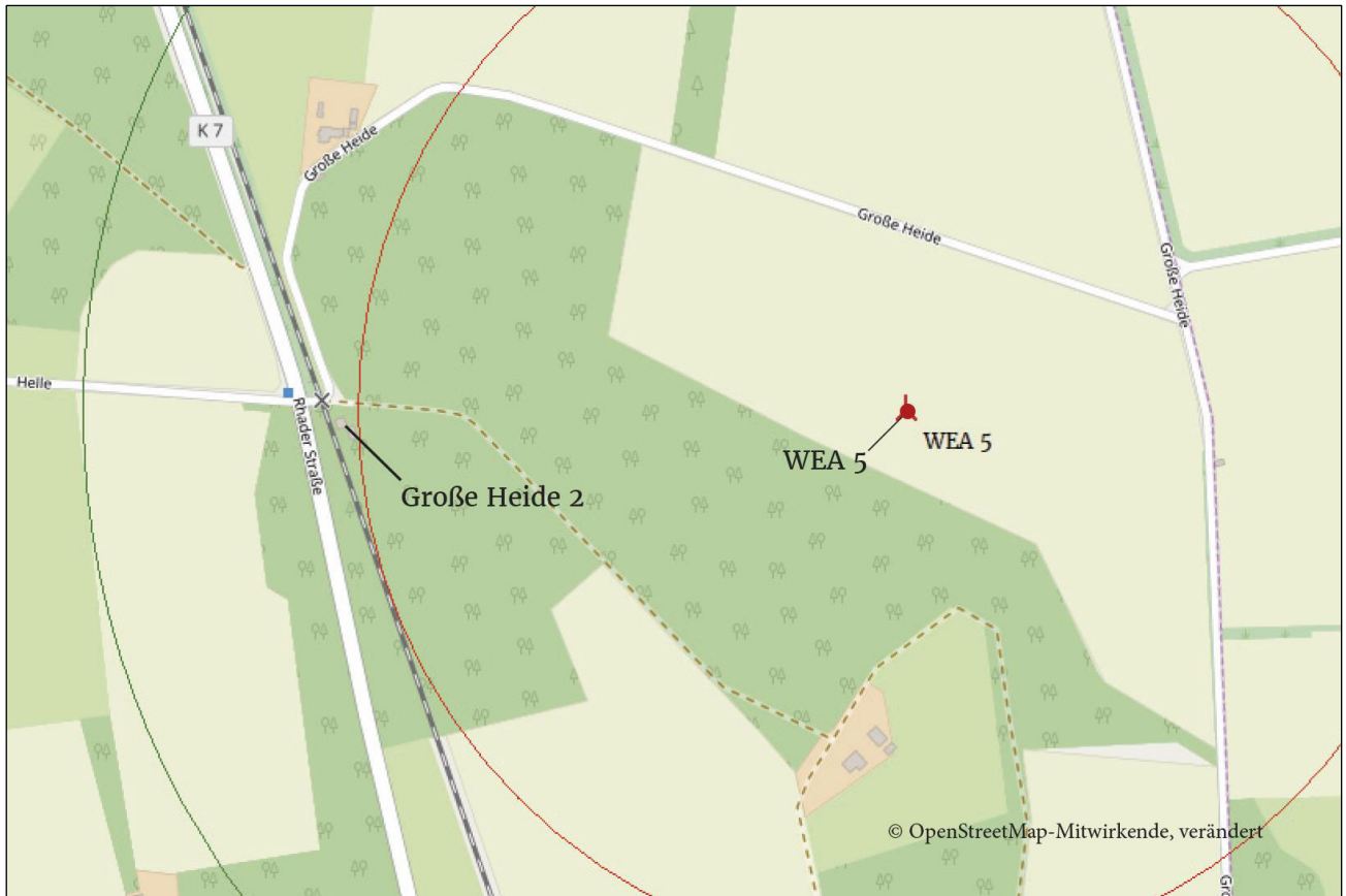
Abb. 12 Standort Große Heide 2: die geplante WEA 5 sowie Abstandskreise (2-fache GH = rot, 3-fache GH = grün)
