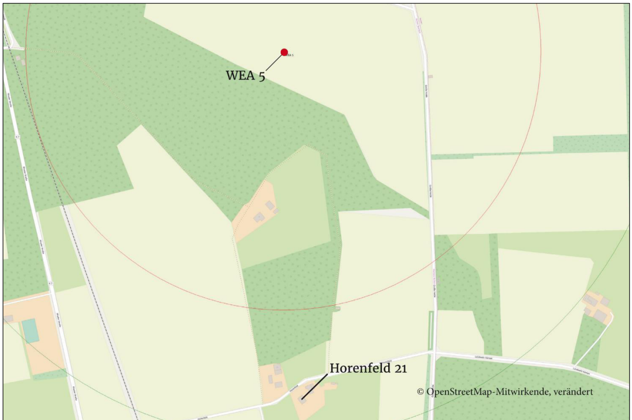
Abb. 23 Standort Horenfeld 21, die geplante WEA 5 und Abstandskreise (2-fache GH = rot, 3-fache GH = grün)
