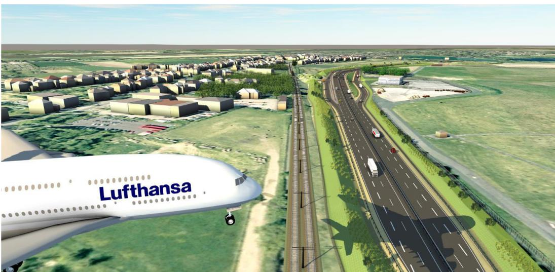
Zur Überführung der Straße „Am Spielberg“ wird die B 8 angehoben. Durch die dichte Lage des bestehenden Pumpwerkes und der parallel laufenden Rheinbahntrasse sowie der Hauptstromversorgungsstrasse des Flughafens, wird der Höhenunterschied zu den Verbindungsrampen auf der Westseite (Bahnseite) mit Stützwänden abgefangen.
