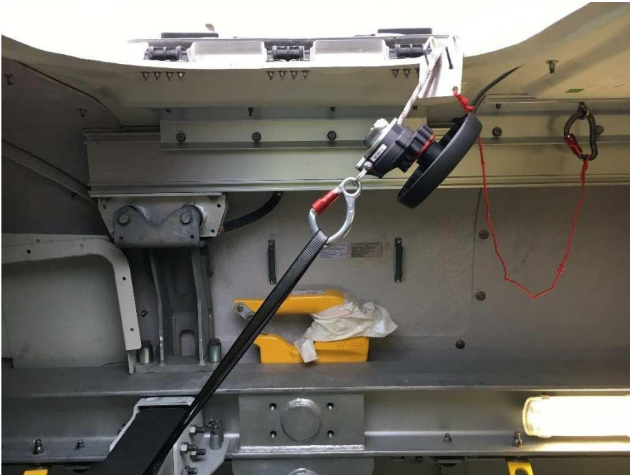
Abbildung 5.16: Abstiegsvorrichtung und Schlinge um den Querträger
