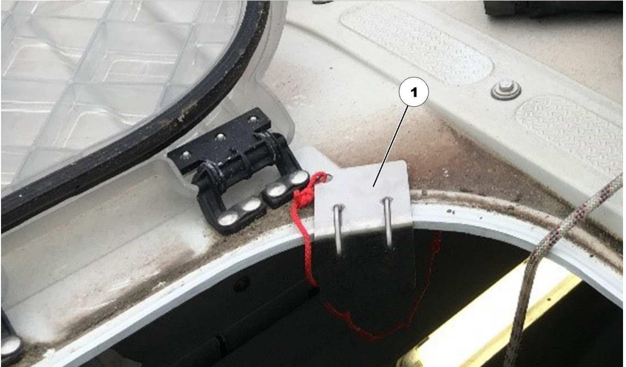
Abbildung 5.15: Kantenschutzvorrichtung am Rand der Dachluke
