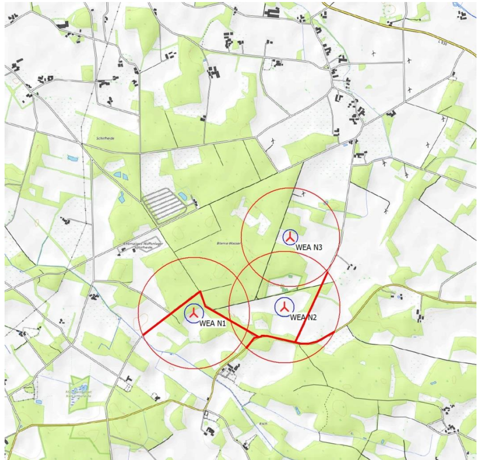
Abbildung.1b: Gefährdungsradien (rot) rings um die neuen WEA und betrachtete Wege- und Straßenbereiche (rot markiert) innerhalb des Gefährdungskreises.
