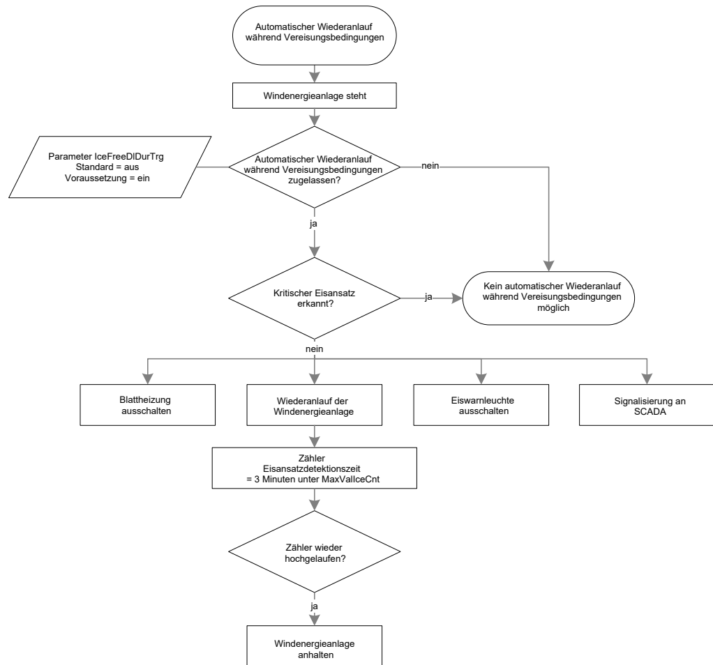
Abb. 2: Automatischer Wiederanlauf während Vereisungsbedingungen
