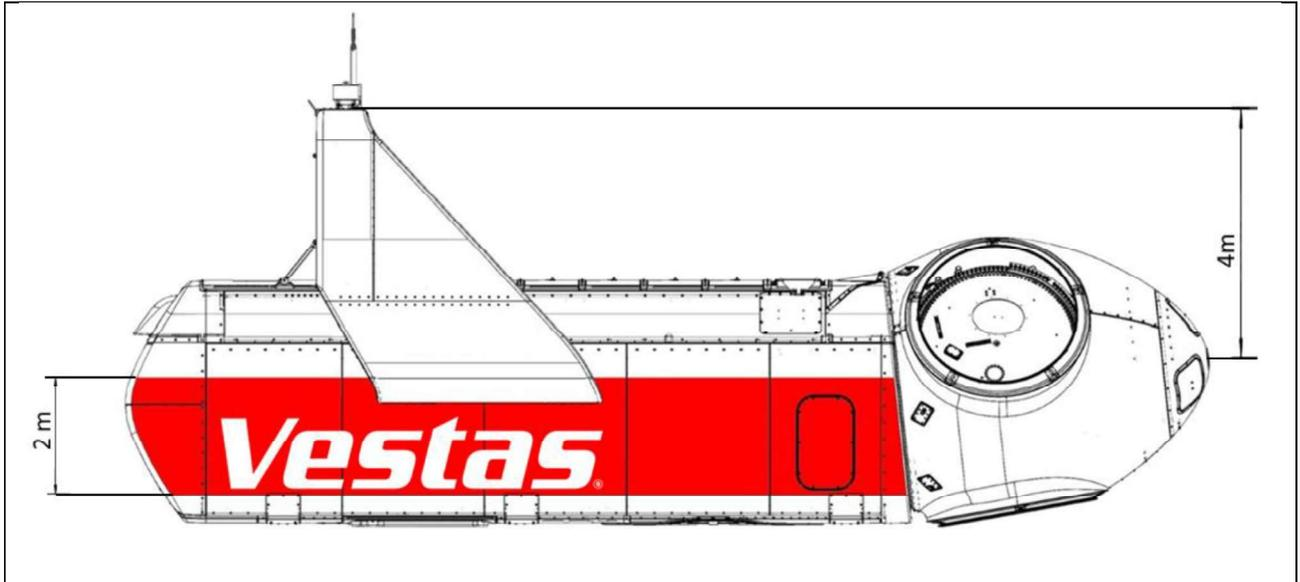
Streifen in RAL 3020 auf einem Maschinenhaus. Die Maschinenhäuser sowie CoolerTop Einheiten von anderen MK-Versionen können im Form Abweichen, jedoch gilt das Konzept des kontinuierlichen, mindestens 2m hohen roten Streifens sowie des Vestas Logos für alle Varianten.
