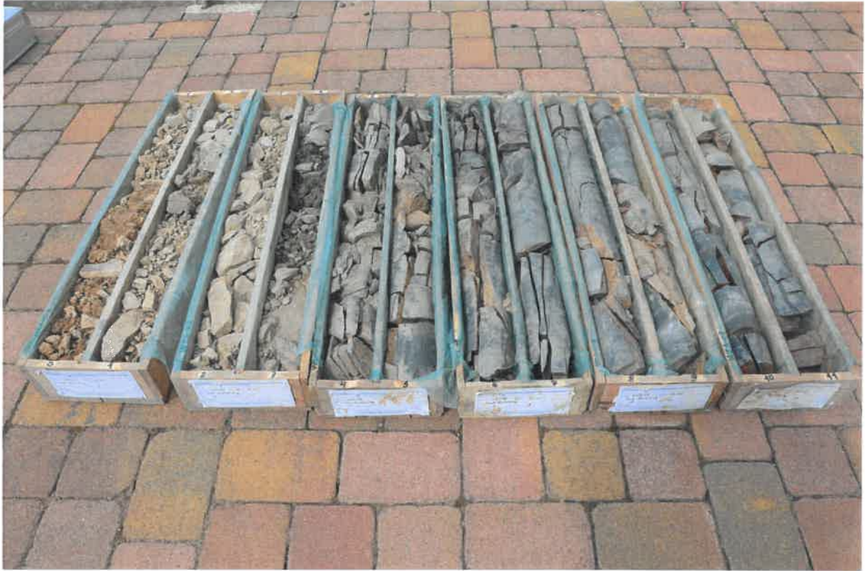
Bild 2 Aufnahme Bohrkern BK WEA 8, Tiefe 0 - 12 m
