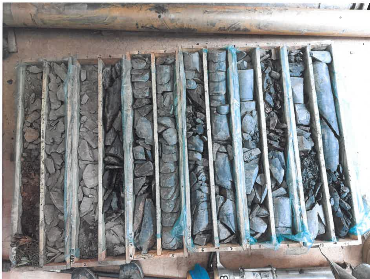
Bild 2 Aufnahme Bohrkern BK WEA 5, Tiefe 0 - 12 m
