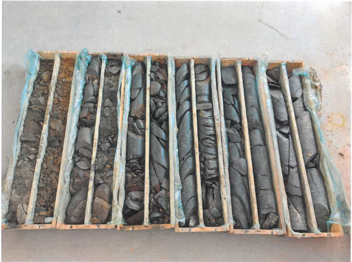
Bild 1 Aufnahme Bohrkern BK WEA 6, Tiefe 0 - 12 m
