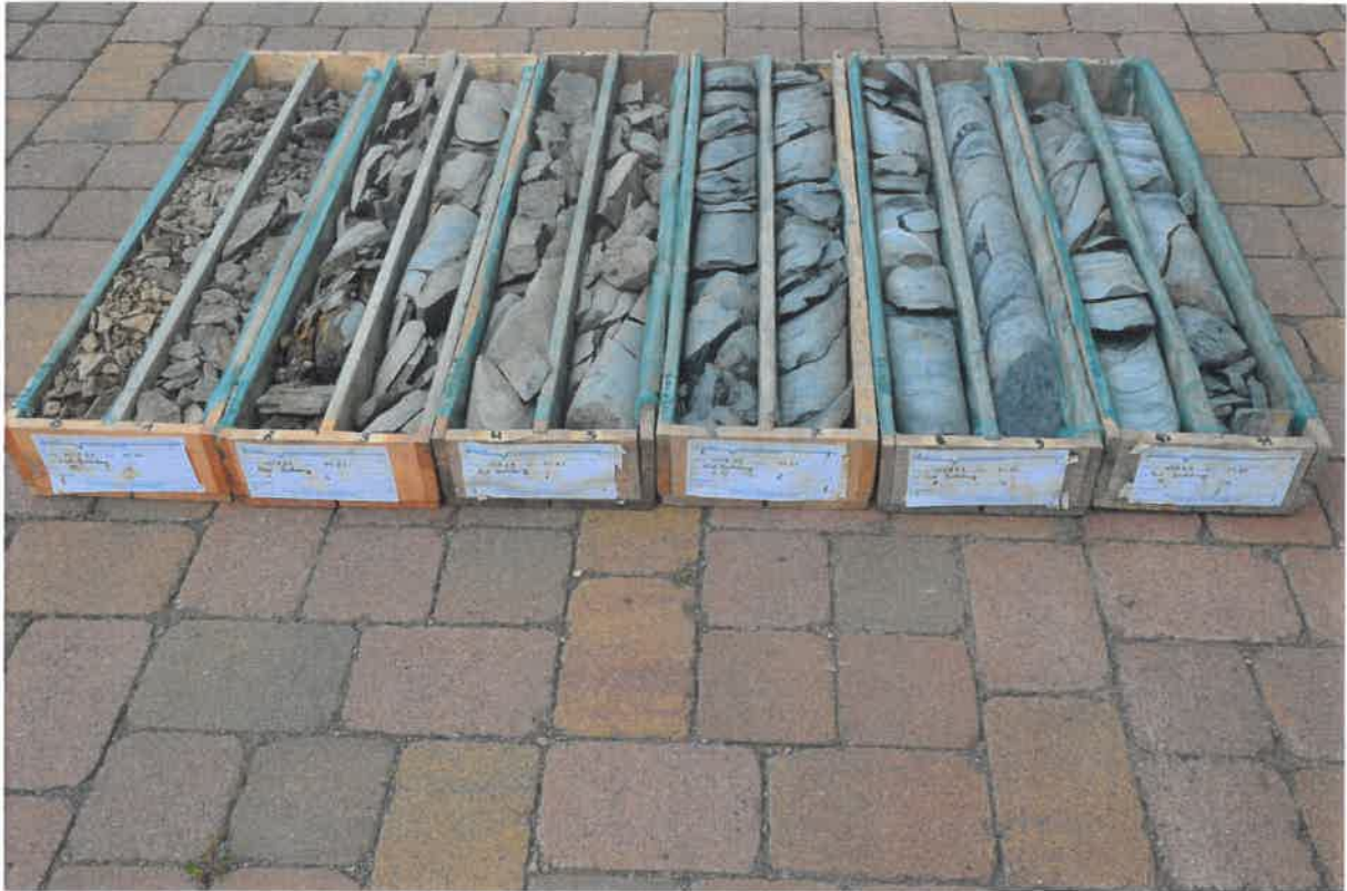
Bild 2 Aufnahme Bohrkern BK WEA 9, Tiefe 0 - 12 m
