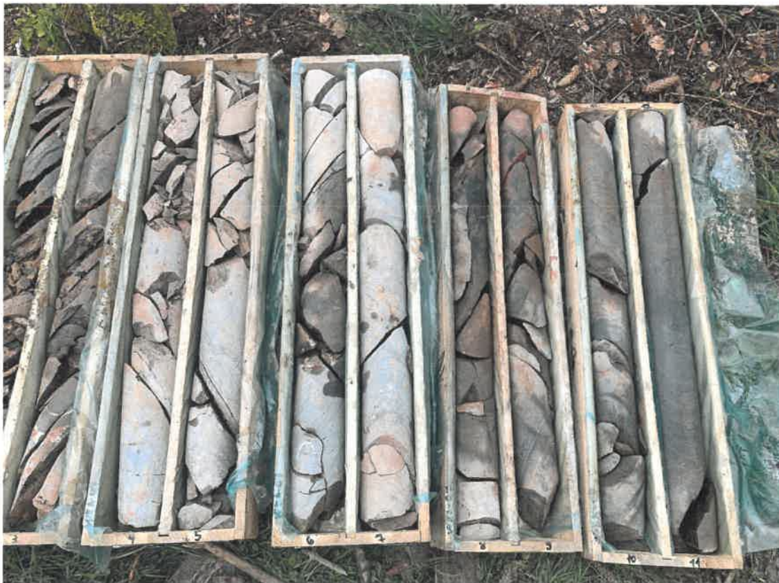
Bild 3 Aufnahme Bohrkern BK WEA 4, Tiefe 3 -12 m
