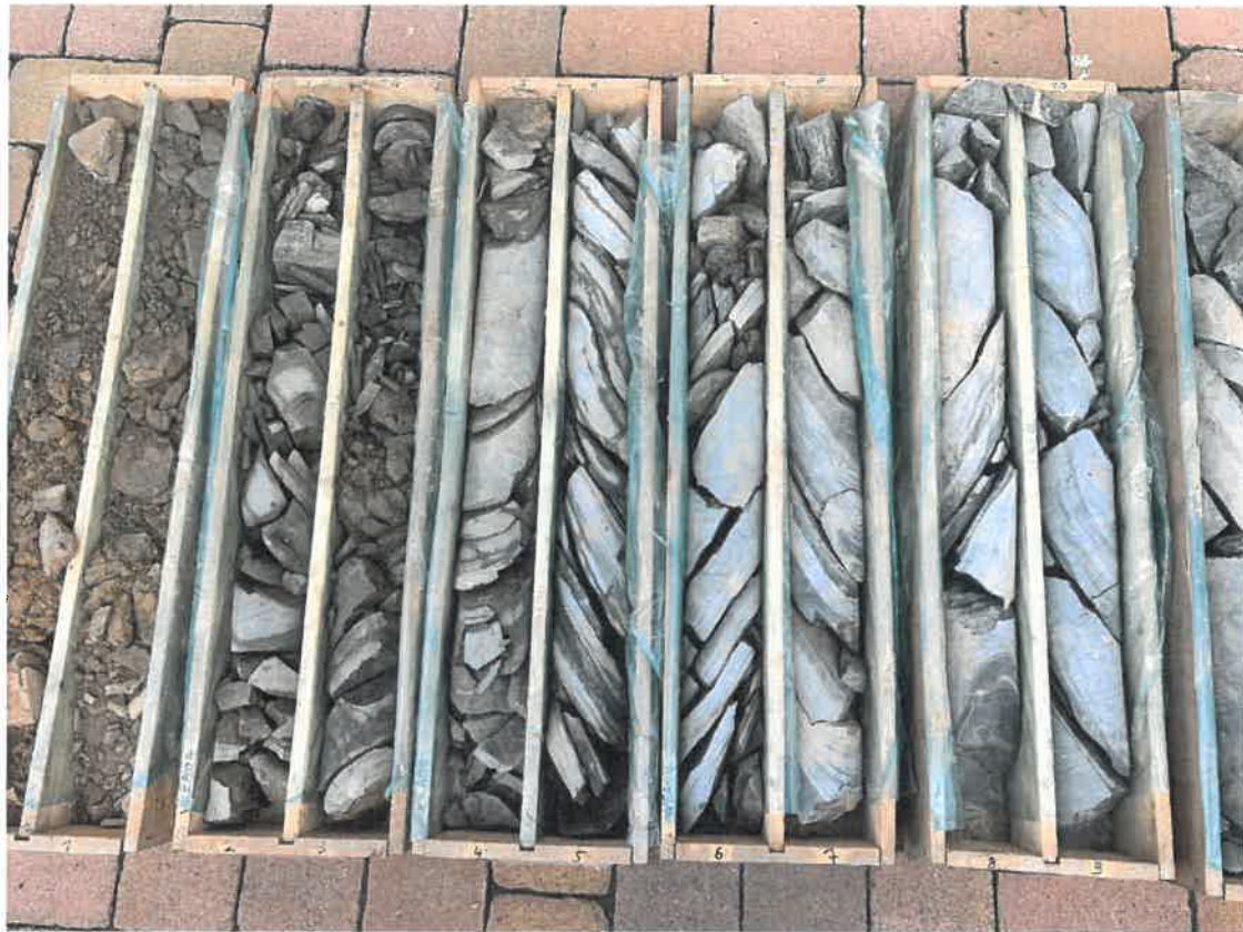
Bild 2 Aufnahme Bohrkern BK WEA 4, Tiefe 0 - 10 m
