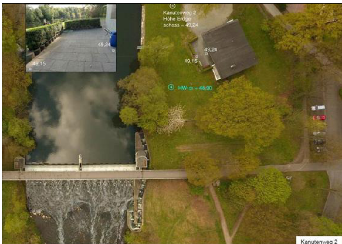
Abbildung 20: Planungssituation HW100 im Bereich Kanutenweg 2 (INGENIEURBÜRO KLEIN, 2022)
