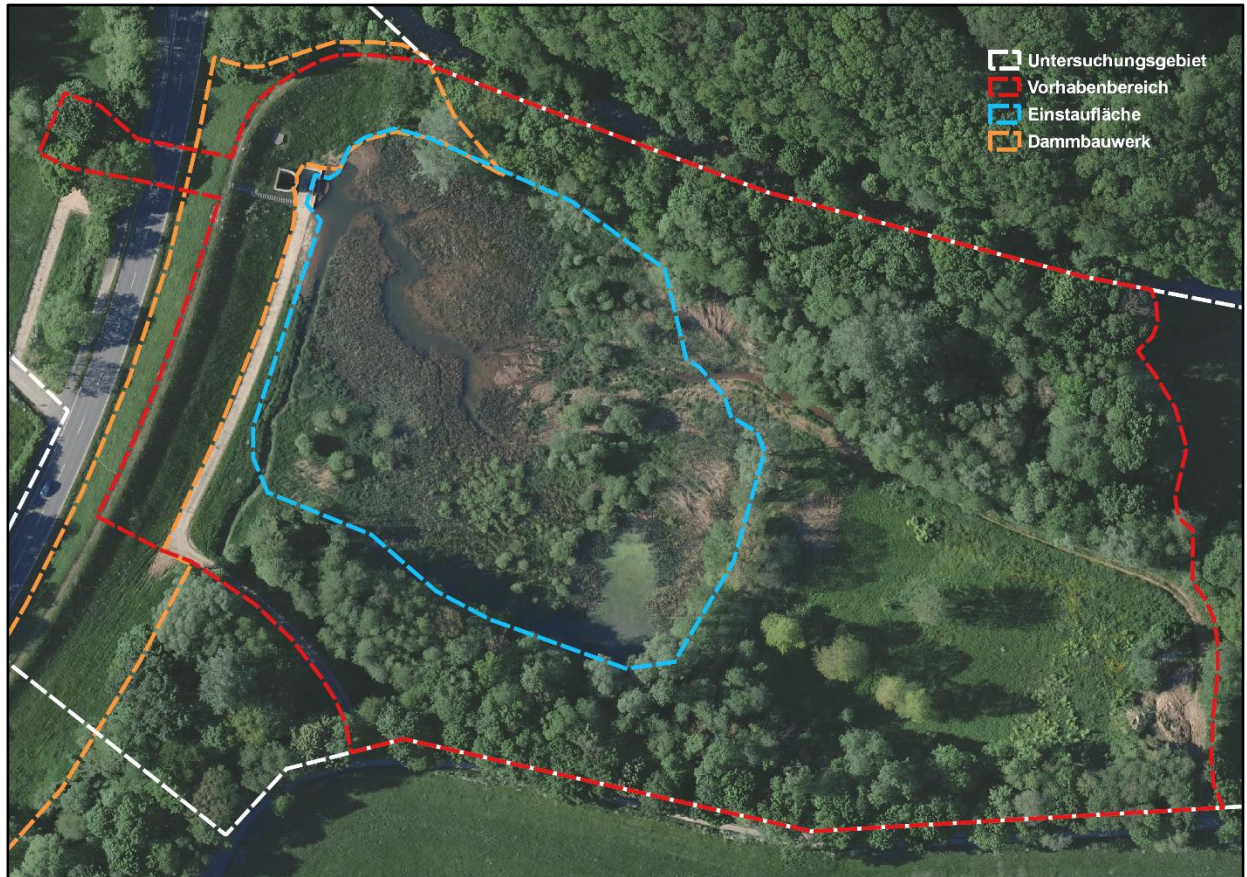
Abbildung 3: Abgrenzung des Vorhabenbereichs mit Stauffläche des HRB.
