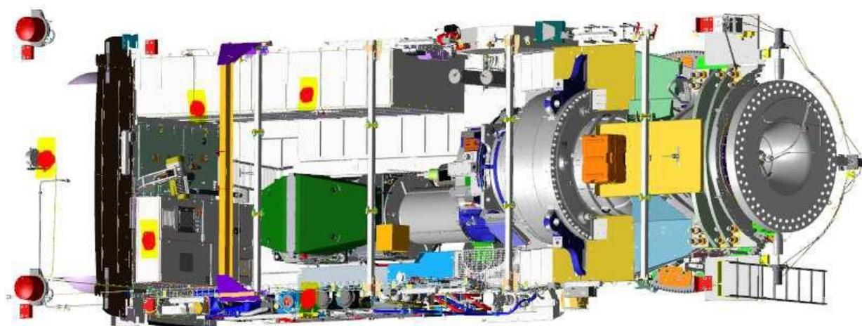
**Abbildung 8.1: Meldesystem (rot) für den Maschinenhausraum (V112 Mk 3)**
