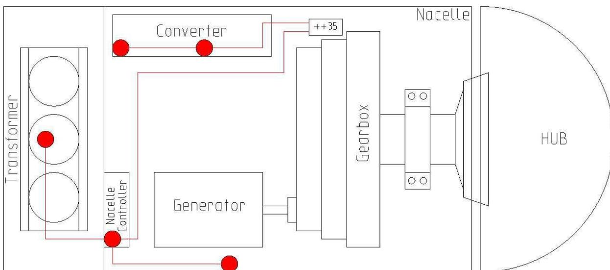
Abbildung 8.2: Systemschemadarstellung der V112-3.45 MW Mk 3
