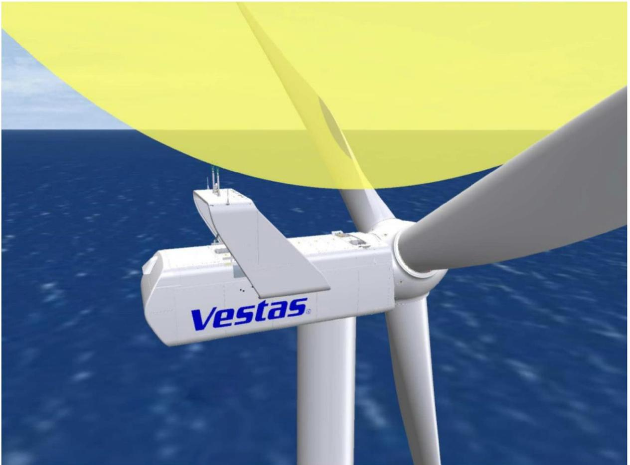
Abbildung 6.2: Blitzkugelberechnung für CoolerTop® (Version Mk 1)
