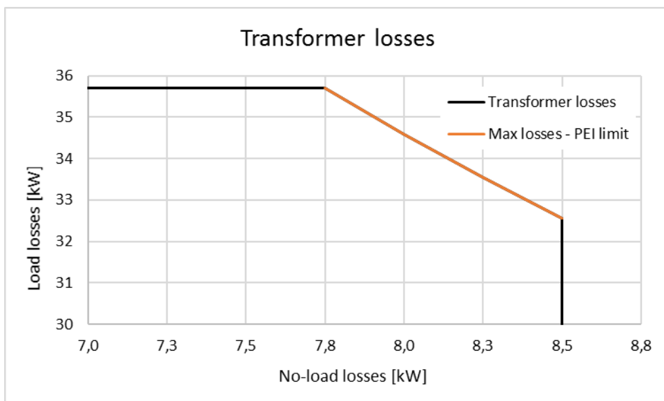
Abbildung 4-1 Transformatorverluste – zulässiger Bereich
