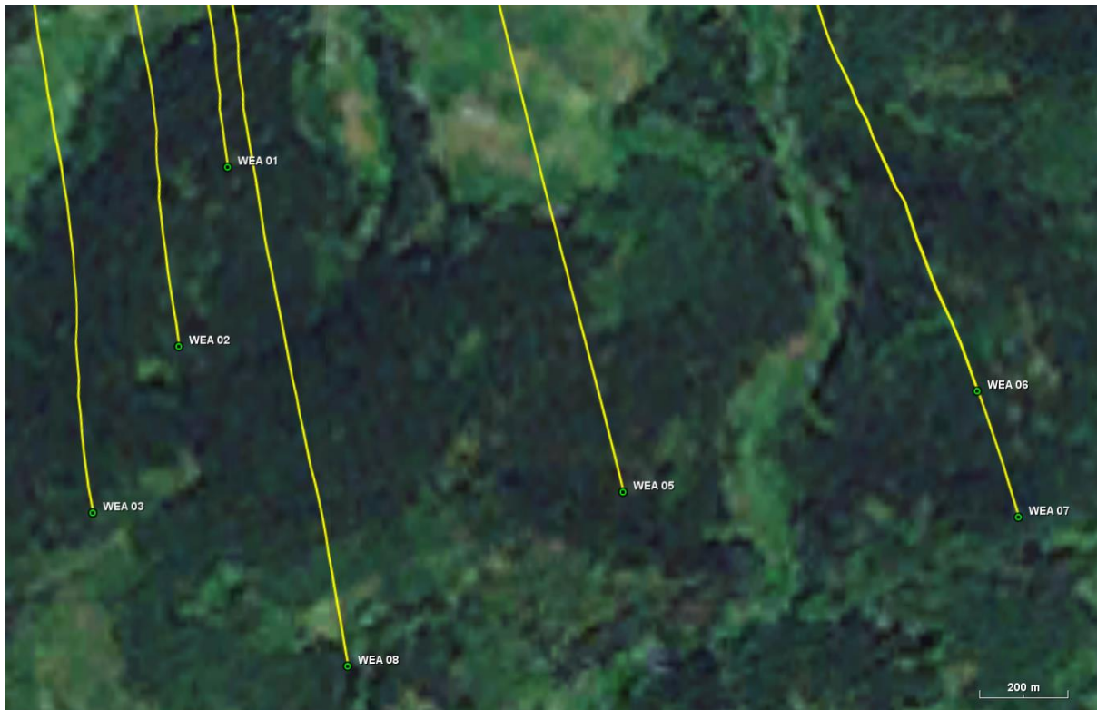
Abbildung 14: Übersicht über den Windpark Bad-Laasphe mit den geplanten Windenergieanlagen (grün). Die Einstrahlungsrichtungen bzgl. der Radaranlage Erndtebrück sind gelb dargestellt.
