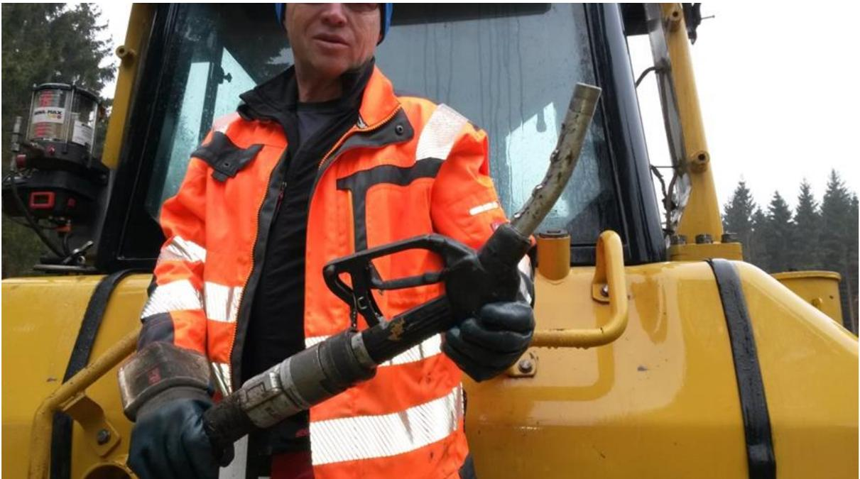
Abbildung 6: Empfohlene Maßnahme: Betankung von Baugerät mit rückschlaggesicherter Zapfpistole
