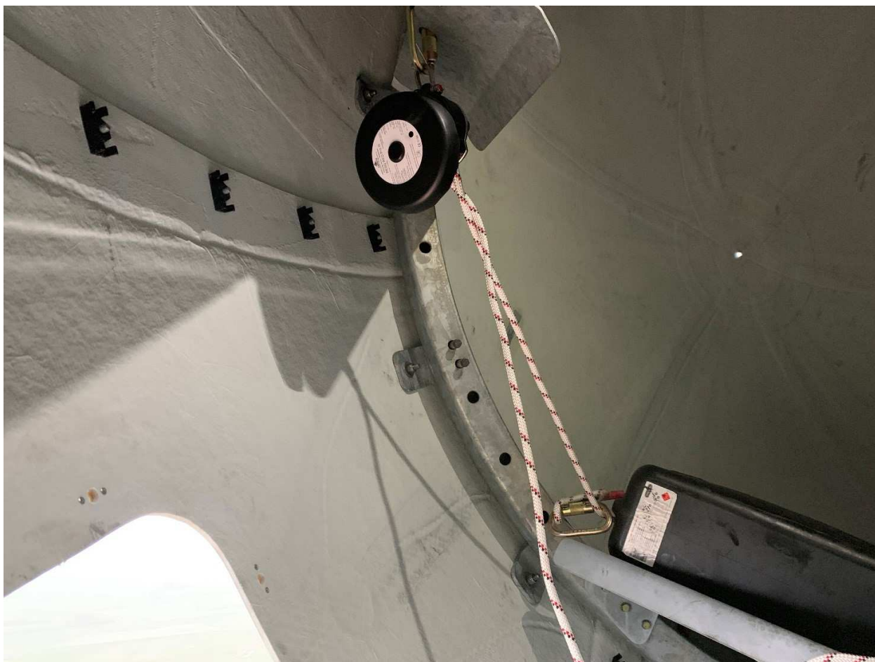
Abbildung 7.30: Aufhängung der Notabstiegshilfe an der Öffnung in der Trittplatte der Nasenkonushalterung (EnVentus™ V150)
