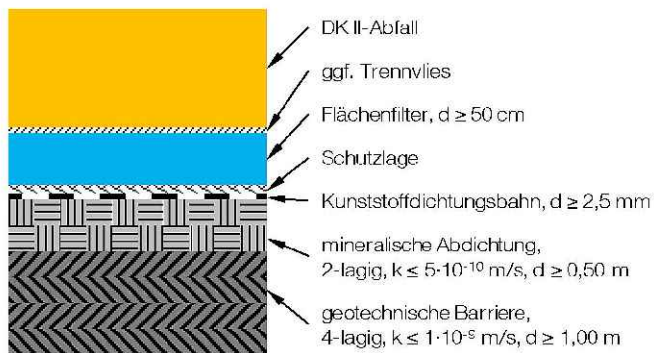
Aufbau Basisabdichtungssystem DK II
