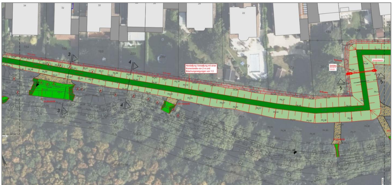
Abb. 3-9: Verwallung im Bereich km 2,76 bis km 2,91 (Lageplan 2- Plan-Nr.: 22666/10290154)
