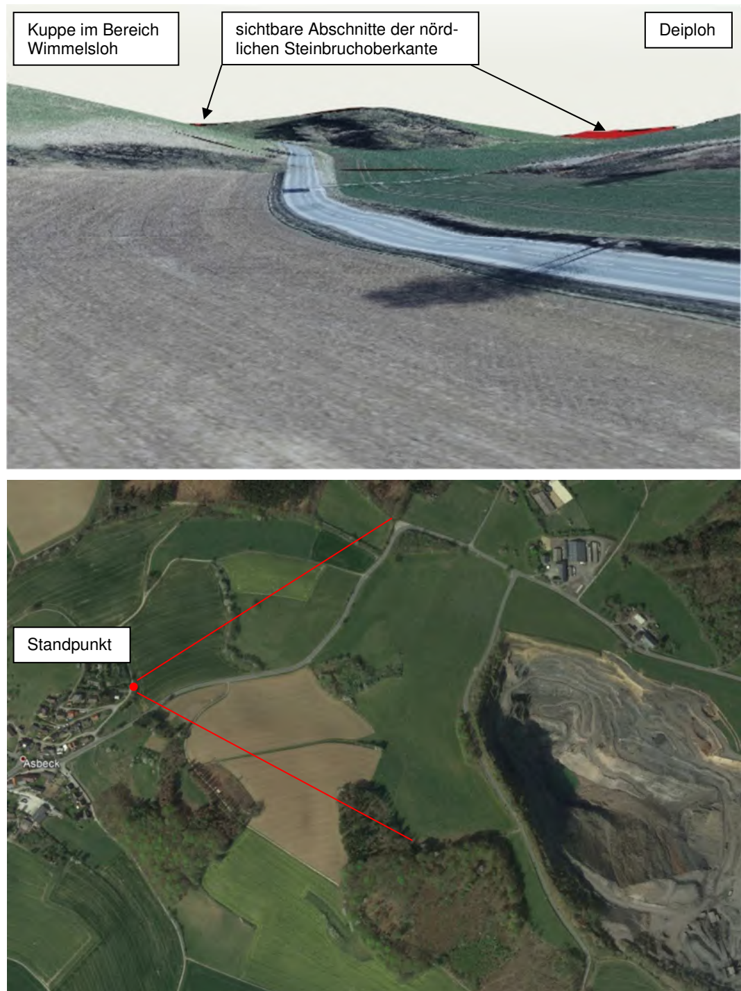
Abb. 23: Digitales Geländemodell - Sicht vom östlichen Siedlungsrand von Asbeck auf den Steinbruch nach Endausbau ohne Berücksichtigung der abschirmenden Wirkung bestehender Gehölzstreifen und Feldgehölze
