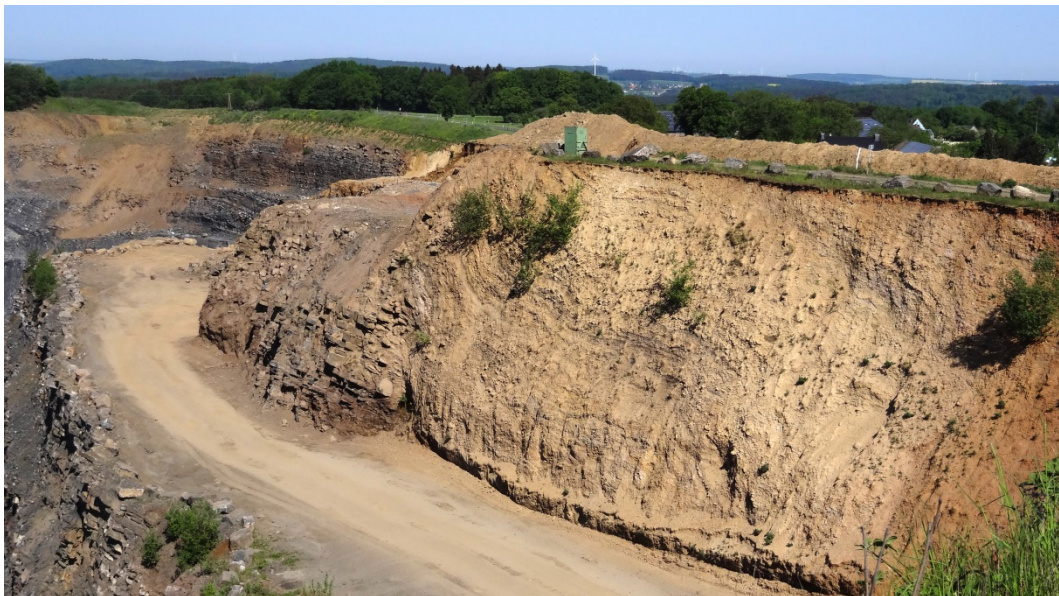
Bild 6-4: Arnsberger Schichten über Hangendem Alaunschiefer (ca. 18 m Schichtdicke), links Gesteinshöcker aus Kulm-Plattenkalk
