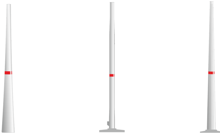
Abb. 5: Farbliche Kennzeichnung am Turm, beispielhafte Darstellung
