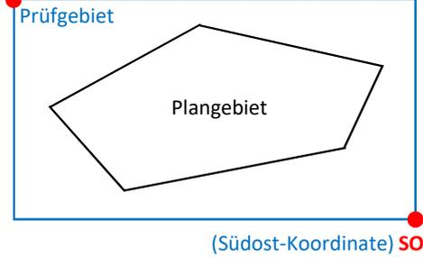
Sie definieren ein **Prüfgebiet** um Ihr Plangebiet in Form eines **Rechtecks** welches durch **zwei Koordinatenpunkte (NW; SO)** aufgespannt wird.
