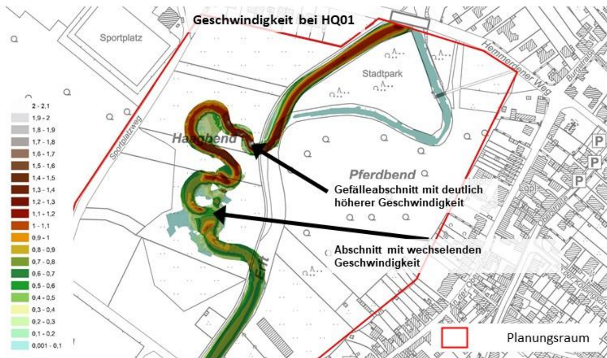
Abbildung 50: Geschwindigkeiten im Gewässerabschnitt 3 für HQ 1
