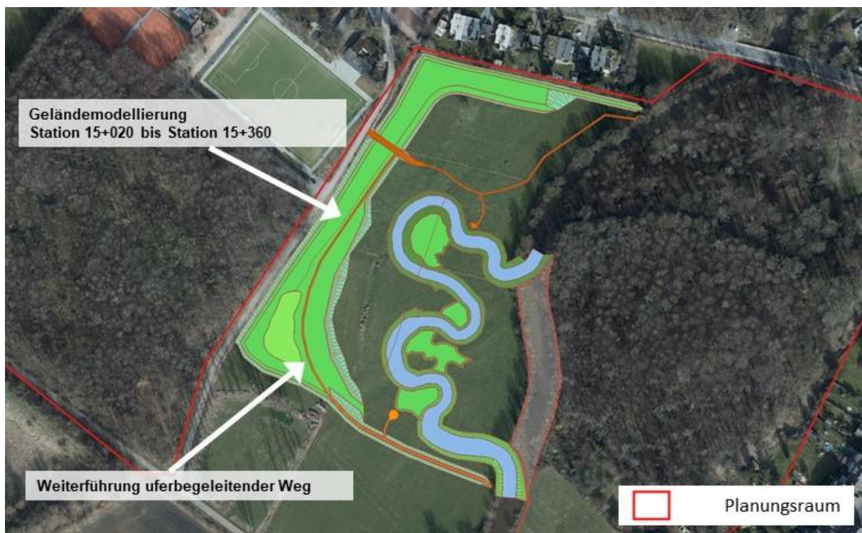
Abbildung 42: Geländemodellierung im linken Vorlandbereich des Sportplatzweges
