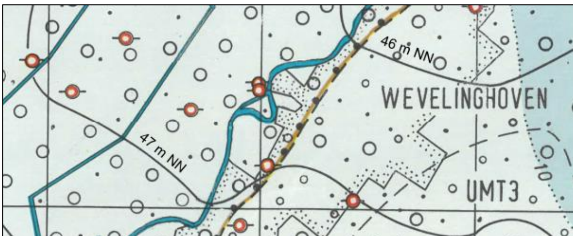
Abbildung 16: Hydrologische Karte für den nördlichen Planungsraum, Grundwassergleichen Stand Oktober 1955 (ICG Ingenieure GmbH, 2022)
