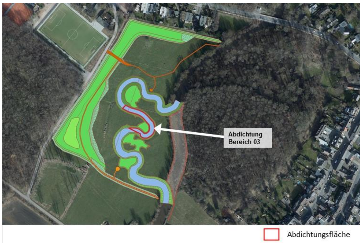
Abbildung 38: Abdichtungsbereiche der neuen Erftsohle Neutrassierung 3
