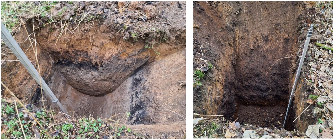
Abbildung 10: Baggerschürfe mit Bodenaufbau aus Bereich 1
