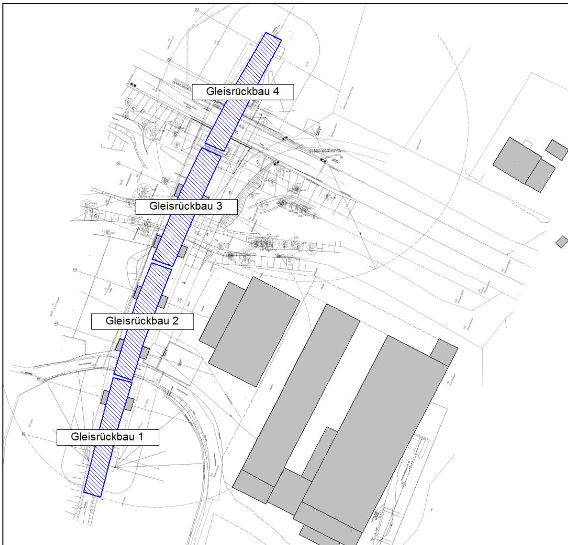
**Abb. 3.2.1** Abschnitte des Gleisrückbaus
