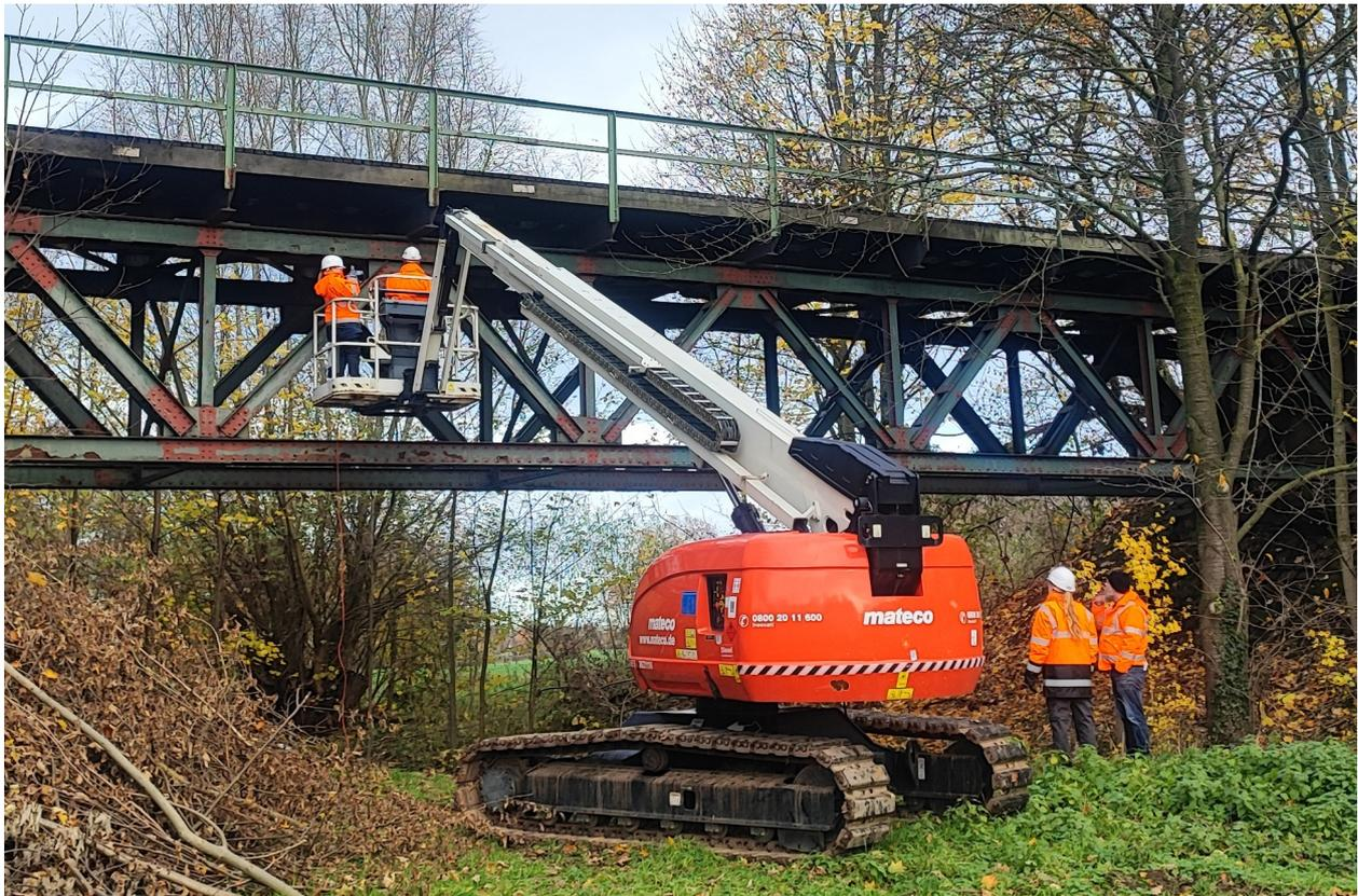
Abbildung 13: Hubarbeitsbühne mit Raupenfahrwerk
