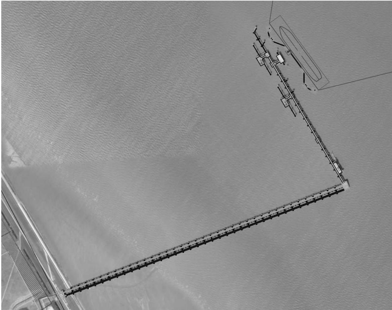
Abbildung 2: Lageplanausschnitt des neuen Anlegers und Position der dort dauerhaft vertäuten FSRU (Schiff von 294 m Länge und 46 m Breite) an der Umschlaganlage Voslapper Groden (UVG)
