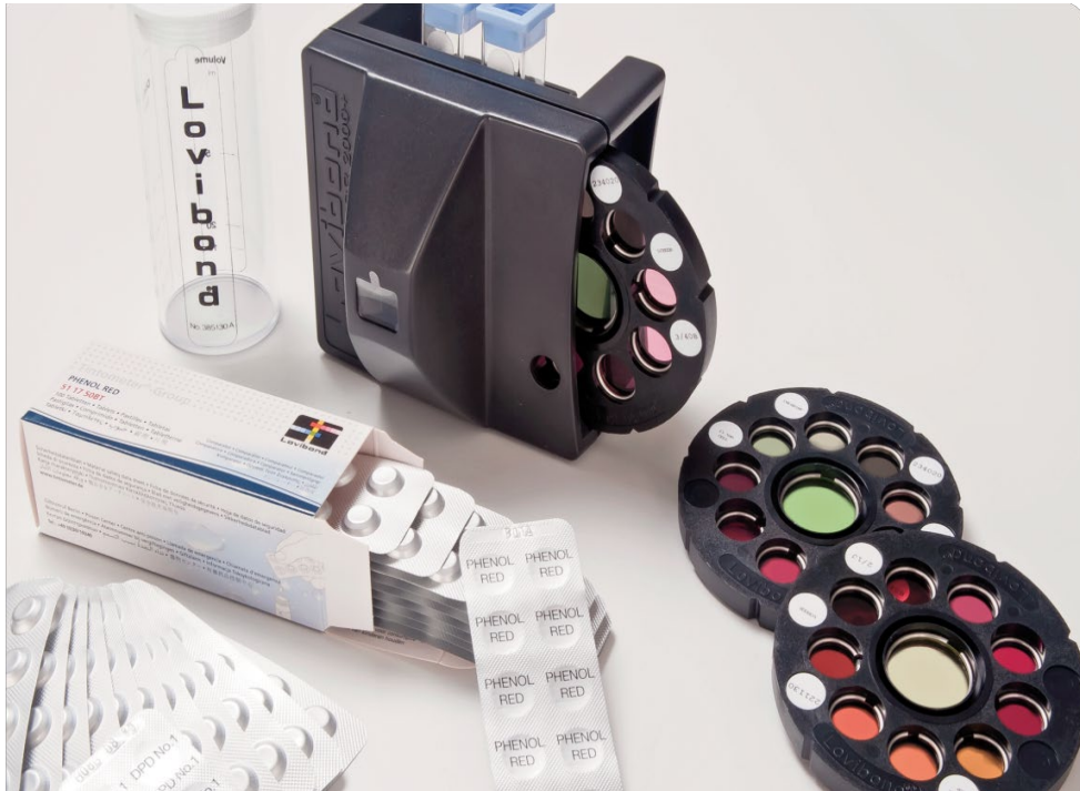
Abbildung 4: Kolorimetrisches System für die Wasseranalytik des Herstellers Lovibond; hier zur Bestimmung des Cl_2 -Wertes der FSRU-Abwasser-Teilströme im Bereich zwischen 0,02 bis 0,5 mg Cl_2/l
