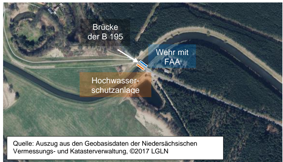
Abbildung 2: Bauwerksanordnung Variante 2 – Wehr und HWSA als zwei eigenständige Anlagen am Bestandsort
