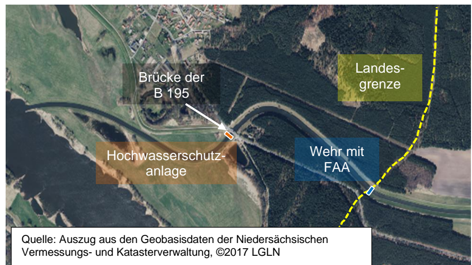
Abbildung 5: Bauwerksanordnung Variante 5 – Wehranlage an Landesgrenze Mecklenburg-Vorpommern, Hochwasserschutz an Bestandsort
