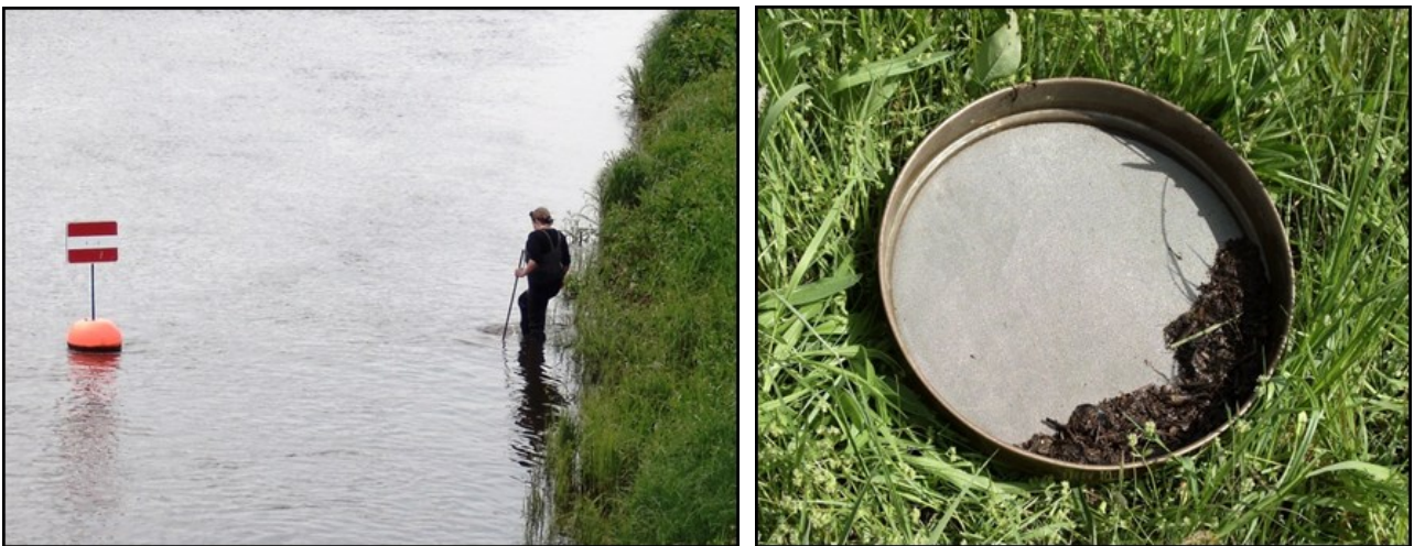
Abbildung 3: links: Kescherprobe, rechts: Siebrückstand einer Kescherprobe
