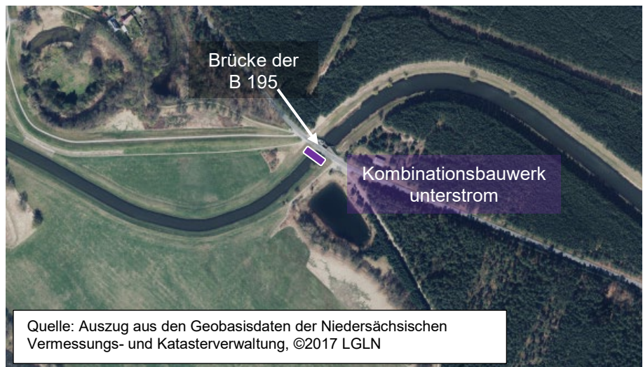
Abbildung 4: Bauwerksanordnung Variante 4 – Kombinationsbauwerk unterstrom des Bestandes
