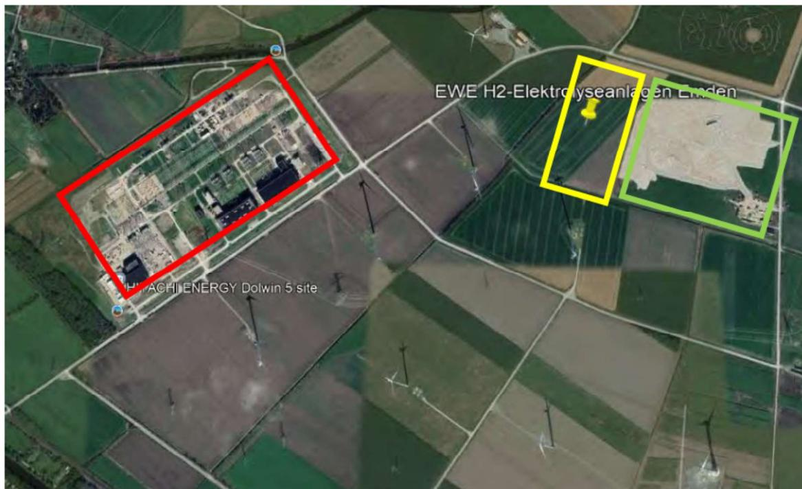
Abbildung 2: Luftbild mit gelber Markierung der Fläche, auf der die Elektrolyseanlagen (EWE) errichtet werden. Markierung „rot“: Umspannwerk Emden-Ost (TenneT) und Markierung „grün“ Umspannwerk Petkum (Amprion)
