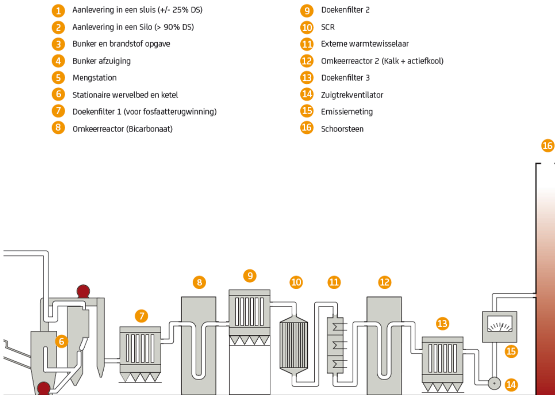
Abbildung 8: Schematische Darstellung der Rauchgasreinigung (Ausschnitt aus Abbildung 6)
