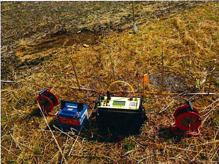
Die geoelektrischen Messungen erfolgten in Form von 1 D - Widerstandsmessungen nach der Wenner – Konfiguration mit Elektrodenabständen  $a$  von 0.5, 1, 2, 3, 5, 8, 12, 16, 20, 25 und 30m. Die Widerstandswerte wurden durch die Messung von mindestens 2 Messzyklen ermittelt.
