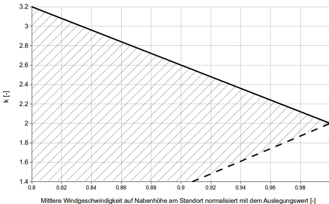
**Abbildung 2.1.2:** Mögliche Kombinationen von normierter Windgeschwindigkeit und Formparameter  $k$  der Weibull-Verteilung (schraffierter Bereich).
