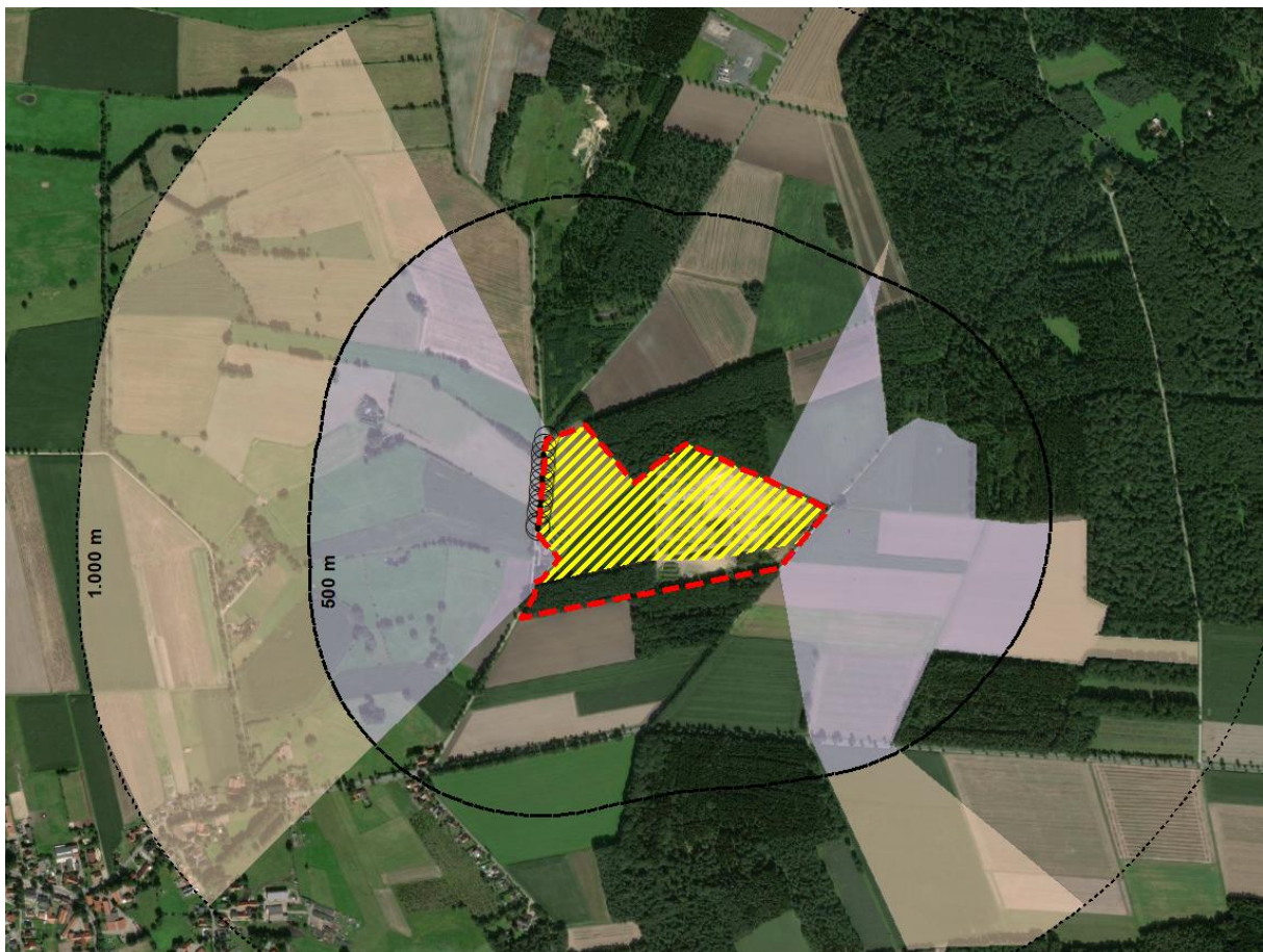
Abb. 14: Sichtbarkeit des Deponiekörpers im 500- und 1.000 m-Umfeld
