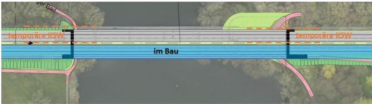
West- und Ostseite, nördlich: temporäre KSW bis zur Fertigstellung der nördlichen Fahrbahn und der dort zu errichtenden dauerhaften KSW (M.-Nr. 2.5 V)
