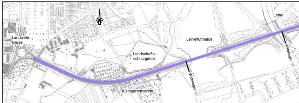
Abbildung 10: Variante W2 „Großbrücke (Leineflut und Leine)“
