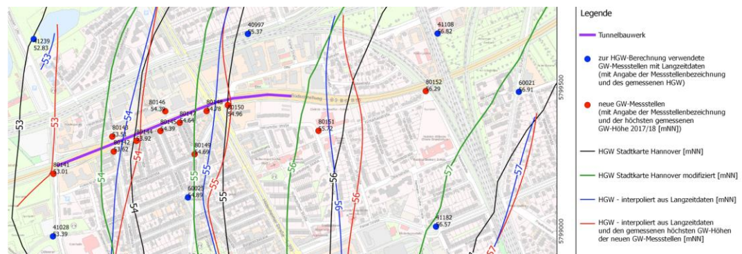
Abbildung 125: Darstellung der Grundwasserstände (rot und grün) im Vergleich mit den Ganglinien der Grundwasserkarte der Stadt Hannover (schwarz)
