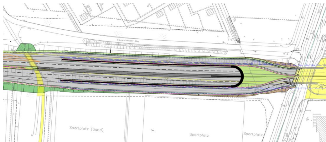
Abbildung 85: Geplante Ein- und Ausfahrrampen westlich der Schützenallee
