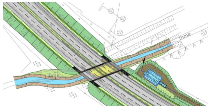
Abbildung 44: Verlegung der Ihme südlich des Südschnellwegs im Zuge der Verbreiterung des Bauwerks BW 02
