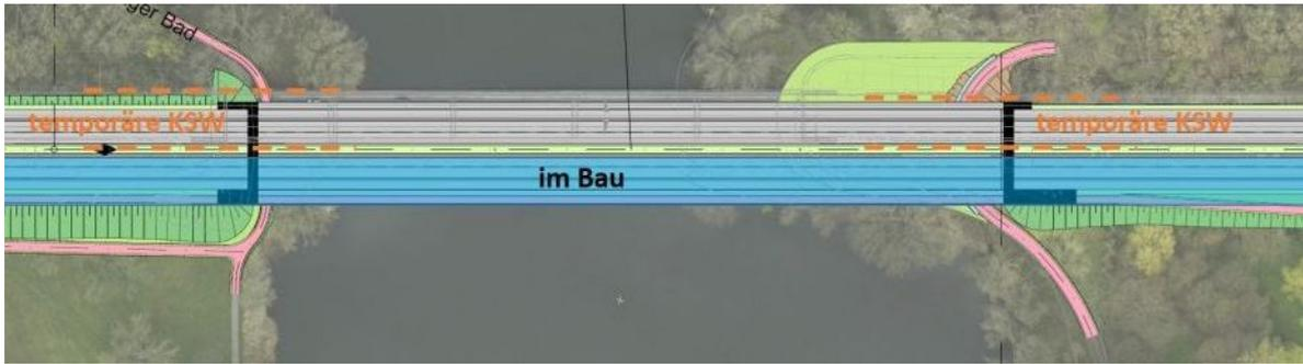
West- und Ostseite, nördlich: temporäre KSW bis zur Fertigstellung der nördlichen Fahrbahn und der dort zu errichtenden dauerhaften KSW (M.-Nr. 2.5 V)
