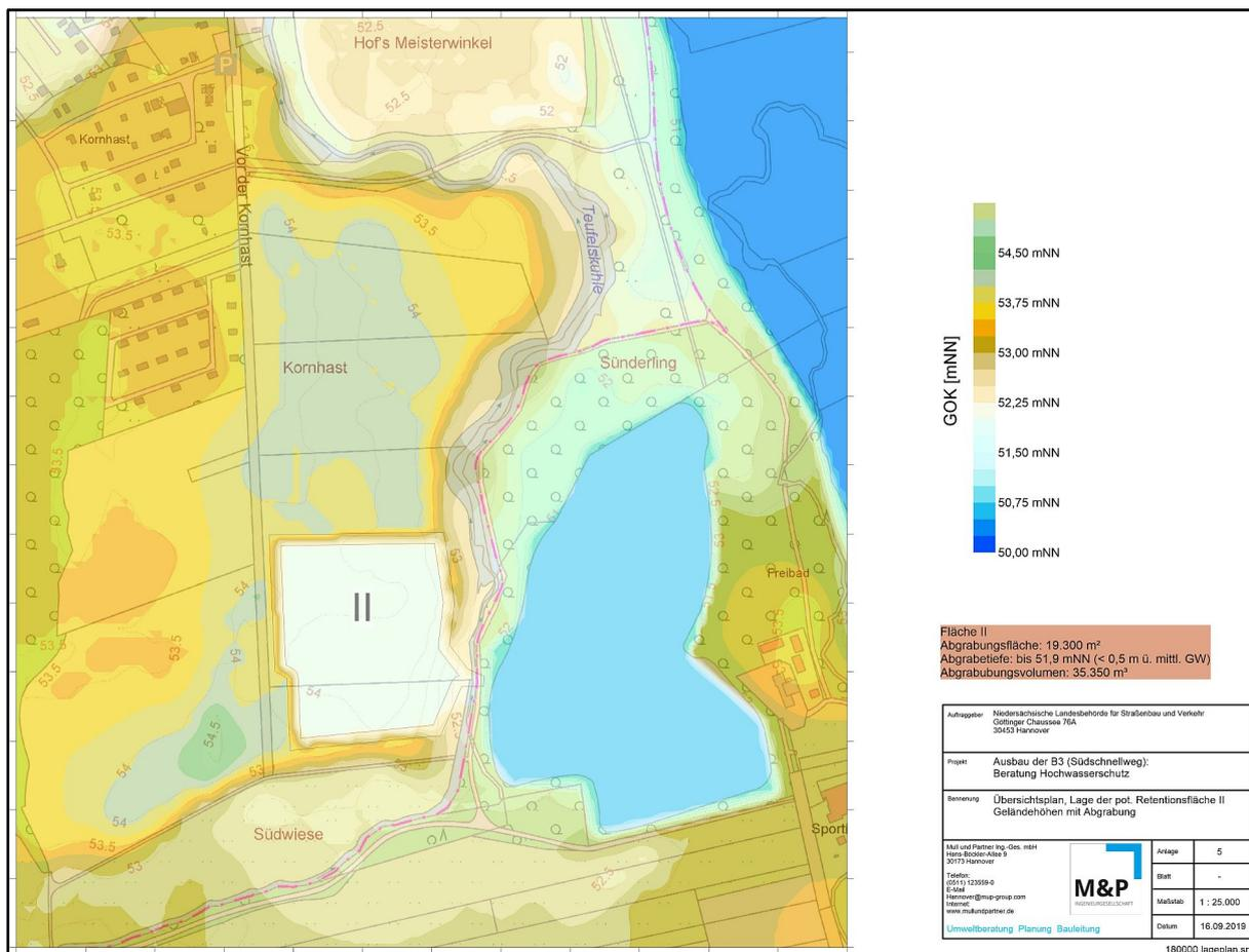
Abb. 9-2 Retentionsfläche „An der Teufelskuhle“, Geländehöhen nach Abgrabung
