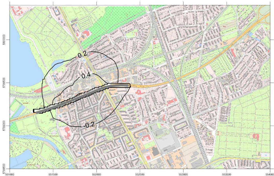
Abb. 1 Prognostizierte Grundwasserabsenkung (in Meter) in der Umgebung des Tunnelbauwerkes bei Absenkung des Wasserspiegels innerhalb der Baudocks und unter Berücksichtigung einer hydraulischen Durchlässigkeit des Verbaus von  $1 \cdot 10^{-9}$  m/s (schwarze Isolinien). Negative Werte bedeuten einen Grundwasseranstieg.
