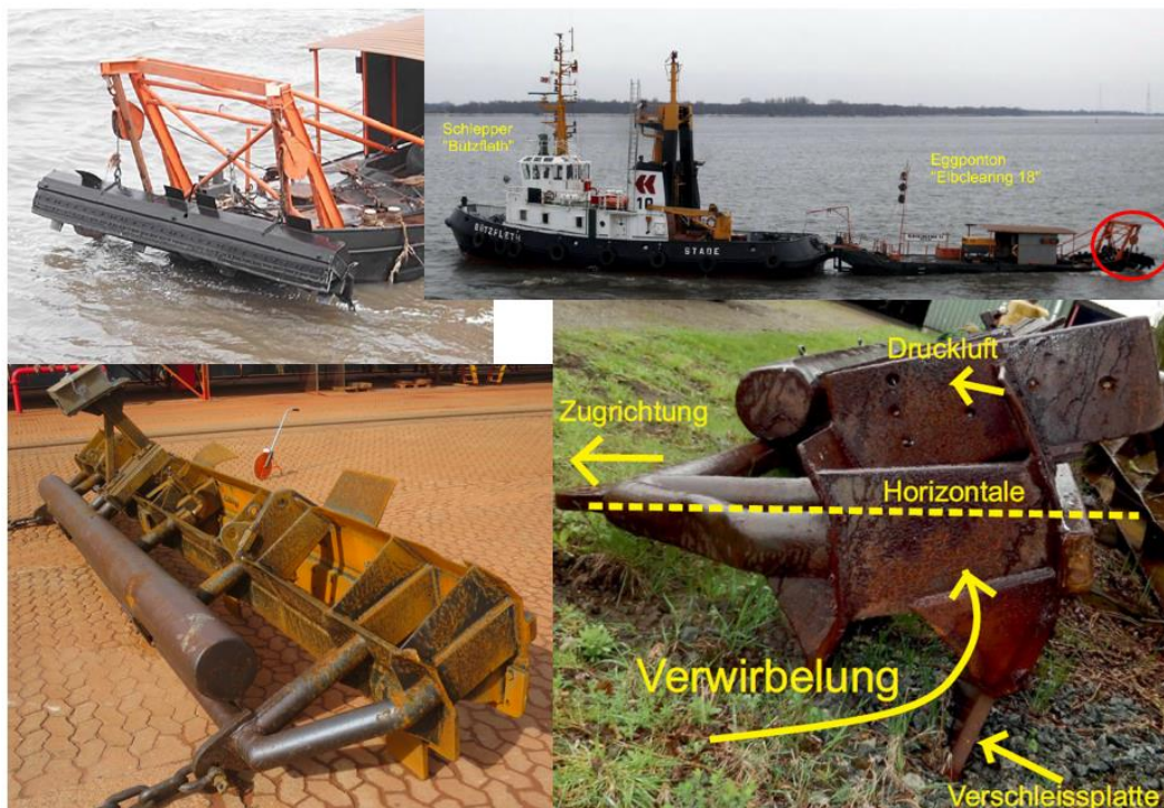
Abbildung 4.1. Pneumatische Egge im Hafen Stade-Bützfleth. Oben links: Egge auf dem Ponton, oben rechts: Schleppverband mit Eggponton und Egge, unten links: Gesamtansicht der Egge, unten rechts: Nahansicht der Egge mit ihren Komponenten.
